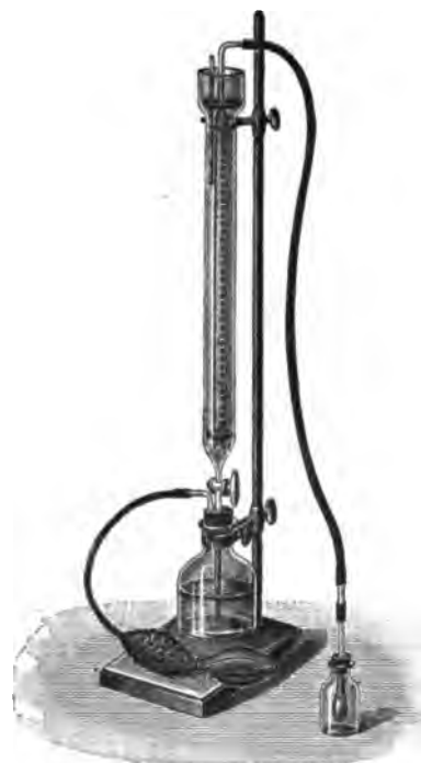
Fig. 1. — Appareil de Baur pour le dosage de l'acide carbonique dans les calcaires.
